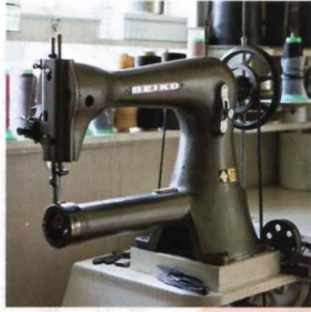
左のミシンよりもパワフルで、厚みのある革にも適した、バッグのまちのように立体的な部分にも使いやすいミシンです。
