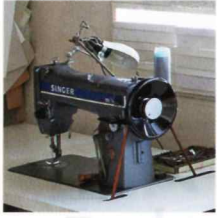
薄手の革や布地を縫うために使う、足踏み式の工業用ミシン。
